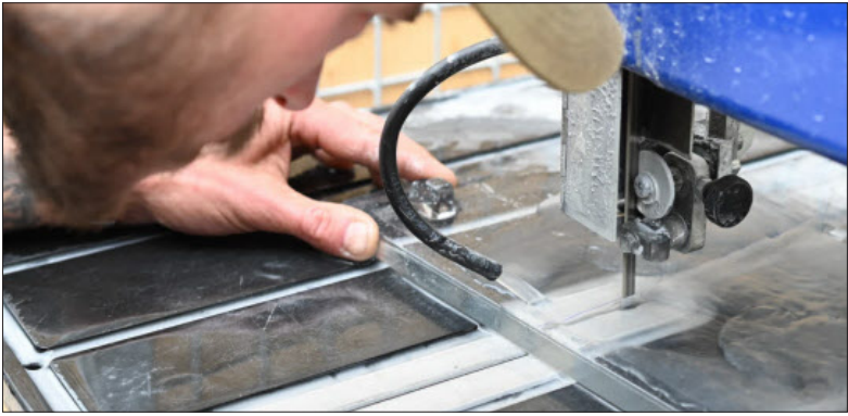
So sieht das aus, wenn Glasziegel passend geschnitten werden. Sie kommen aus Frankreich und geben dem Haus seinen einmaligen Charakter.
